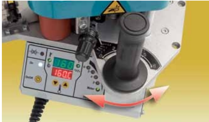
Briaunavimo medžiagos greitis reguliuojamas mikroprocesoriaus pagalba
