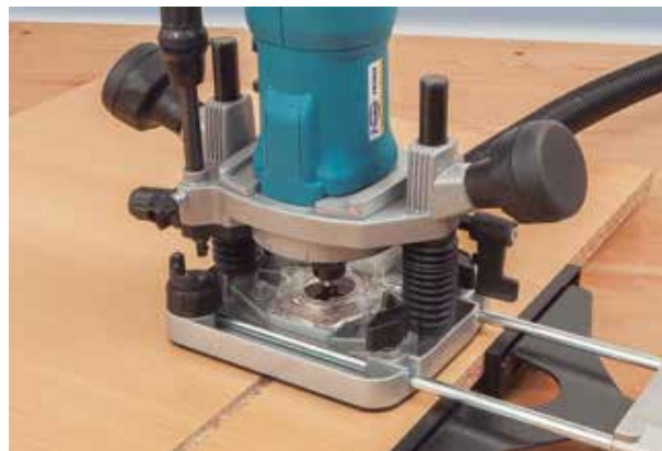
Frezavimo atraminis padukas komplektuojamas su reguliuojamu gylio nustatimu ir šonine kreipiančiąja atrama.
